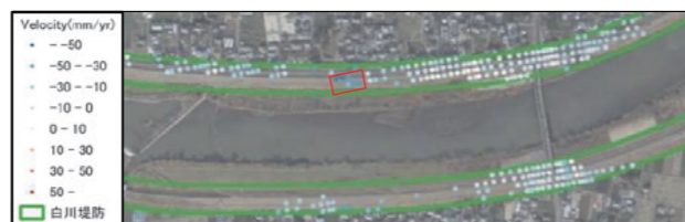
図-4 SBAS解析による白川付近変位箇所の抽出
