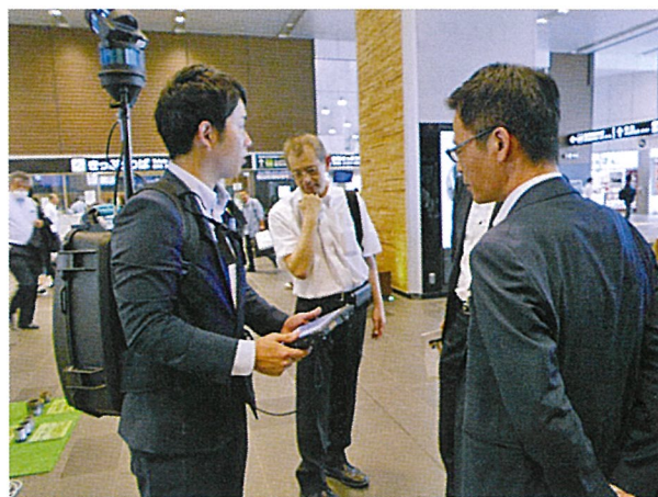
写真-1 BLS式TLS 測量体験 背負って富山駅構内を測量中
