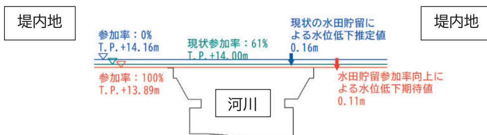
図-7 水田貯留の参加率による最大水位の変化(計画規模降雨・代表地区)
