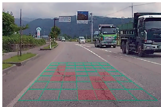
図-2 AIによる舗装のひび割れ解析
