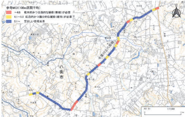
図-3 MCI区間平均による診断結果の可視化
