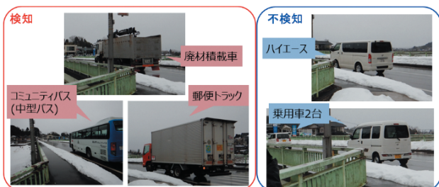
写真-1 大型車センサーの検知、不検知事例
