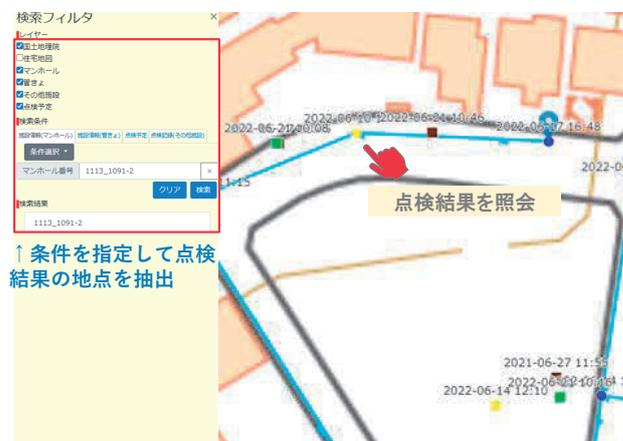
図-14 地図画面上での点検結果管理
