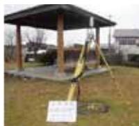
地球上の位置及び平均海面からの高さを正確に求めるための測量であり、電子基準点・三角点・水準点等から構成されております。トータルステーションによる従来型測量に加え、GNSSによる観測も多く行っております。
