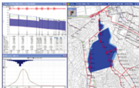
「分布型雨水流出モデル」での浸水解析シミュレーション
