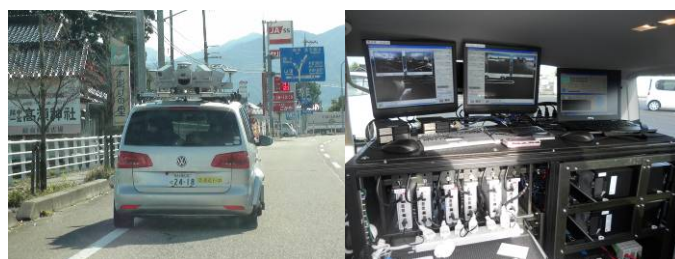
写真-1 MMS計測状況
