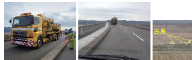
写真-1 大型点検車両
