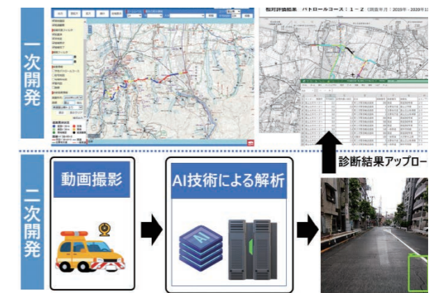
図-6 二次開発概要と一次開発プラットフォームとの関係
